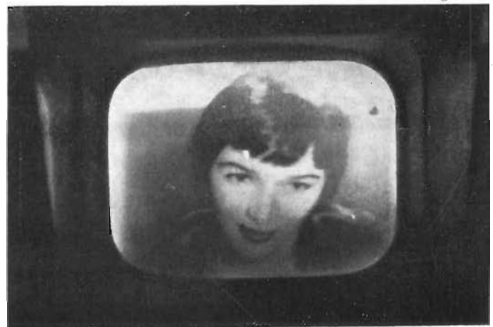
Immagine televisiva ottenuta con sistema a 310 linee e tubo iconoscopio.
